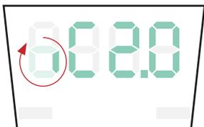
**Normalbetrieb: Karbonatorpumpe EIN**
